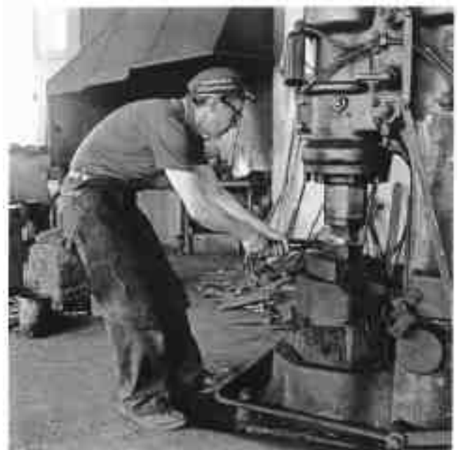
Il farriero che lavora con il martello a motore
